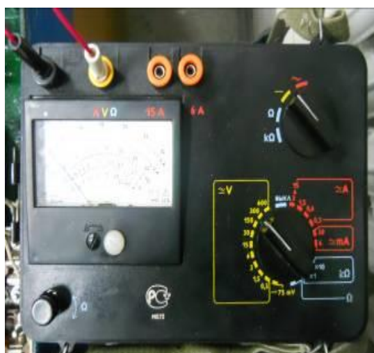
Рисунок 8 – Настройка прибора ЭК-2346
