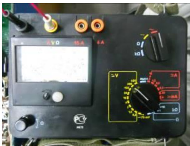
Рисунок 10. Настройка прибора на измерение переменного напряжения
